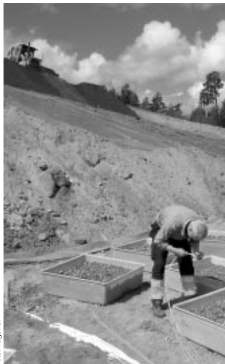
Installation av lysimetrar, Tveta Återvinning.
